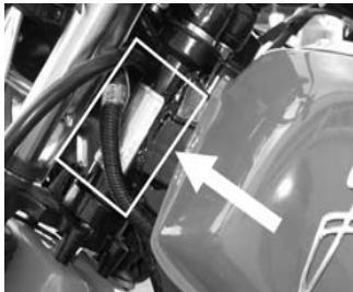
Příklad identifikačního štítku na hlavě rámu
