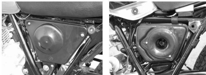
Příklad uložení vzduchového filtru
