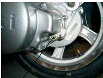
Šroub pro kontrolu hladiny převodového oleje u motocyklů objemu 50ccm.
