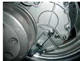
Šroub pro kontrolu hladiny převodového oleje u motocyklů objemu 125, 150, 250. Je nutné demontovat kryt variátoru!!!
