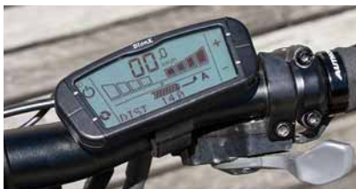
Displej hlásí stav akumulátoru a také to, jestli jej vysáváte nebo dobíjíte rekuperací. Tlačítka si zvolíte, jak moc má motor pomáhat.
