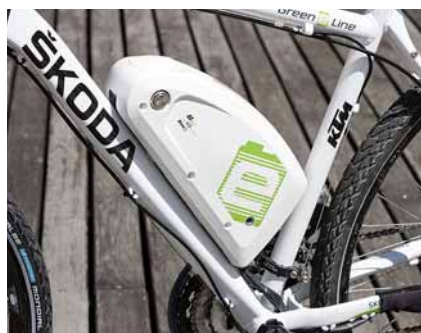
Zdrojem energie je výměnný akumulátor na rámu. Dobíjí se asi čtyři hodiny a vystačí na 105 km, existují ale i kola s větším dojezdem. Škoda prodává elektrokola KTM s motorem BionX.
