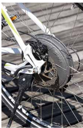
Zdrojem energie je výměnný akumulátor na rámu. Dobíjí se asi čtyři hodiny a vystačí na 105 km, existují ale i kola s větším dojezdem. Škoda prodává elektrokola KTM s motorem BionX.
